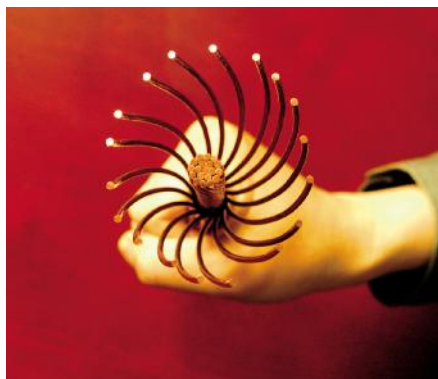
中铁建电气化局康远公司技术人员，在展示他们研制的超细晶强化型铜镁合金绞线散开时的外观细节。（肖雅文摄）
