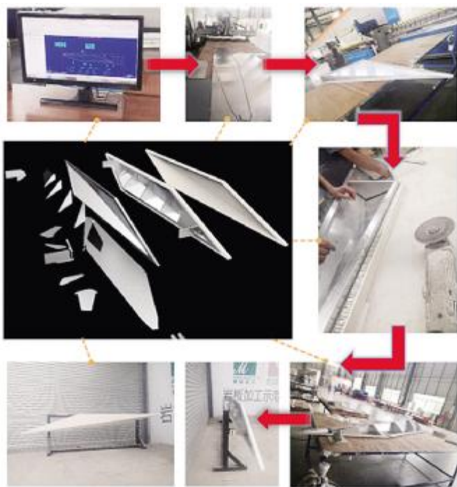
幕墙遮阳构件预制加工流程图
