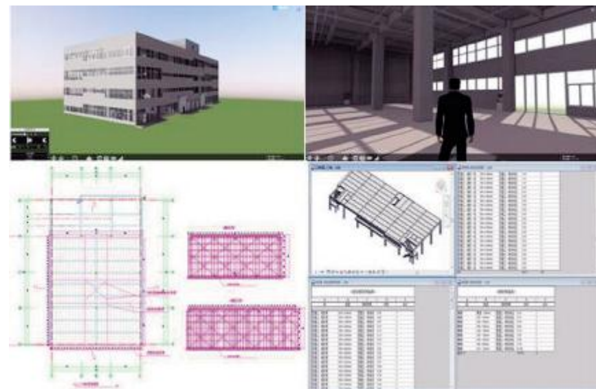
图6 厂房高支模方案绘制及模板工程量计算
