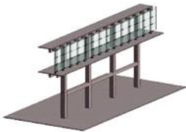
图 13 BIM 三维幕墙深化设计
