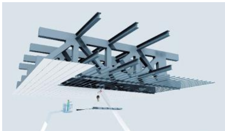
桁架下表皮铝板吊装模拟
