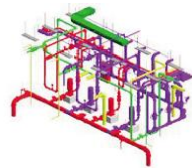
图7 设备房管线综合方案交底
