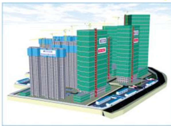
图6 多塔三维布置图
