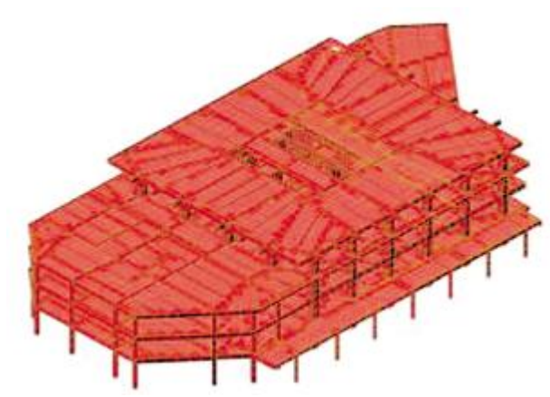
图9 墙柱梁板配模图
