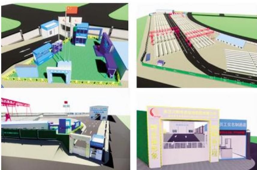
图 2-2.指挥部、预制梁场 BIM 模型图
