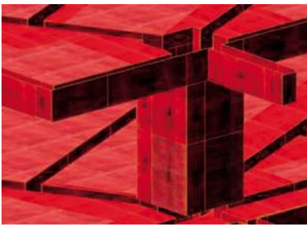
图10 梁柱板配模三维节点详图
