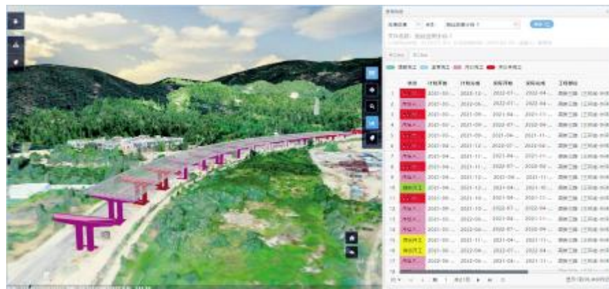
图 7.BIM 形象进度三维展示图
