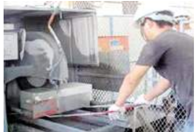
图 3 非标准砌块工厂化集中加工
