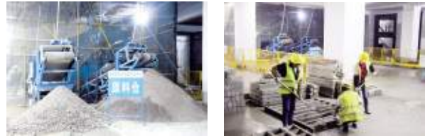
图 7 固体废料收集、破碎及砌体制作
