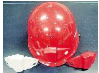
图 1 安全帽上的无线定位终端
