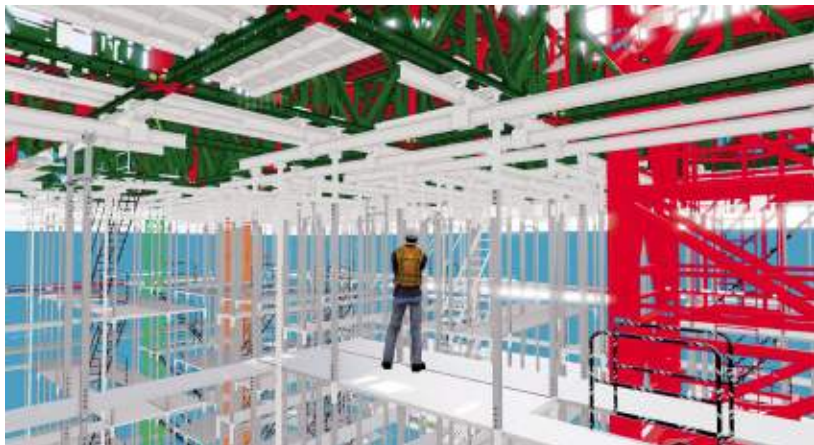
图3 顶模深化设计及工况模拟
