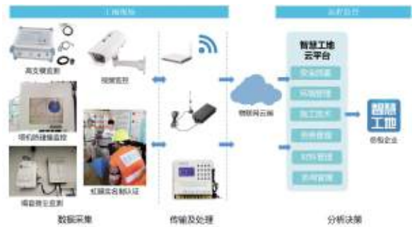
图 9 物联网数据传输流程
